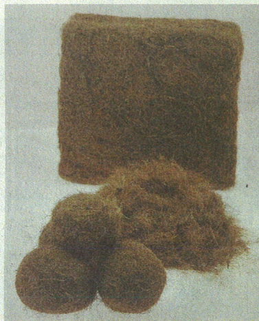
Kugeln aus Seegras besitzen eine hohe Wärmespeicherkapazität. Eine perforierte Membran schluckt Schall. Beton kann in seine Einzelteile zerlegt werden. [Fraunhofer]
